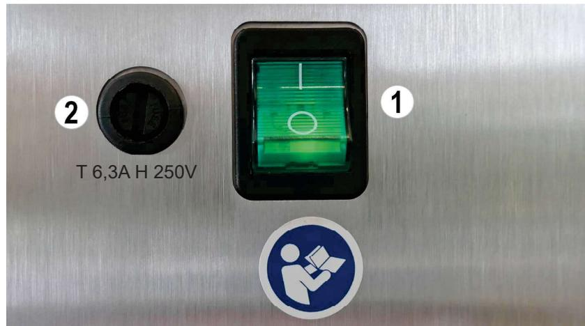
Le poste de traitement est équipé d'un interrupteur principal ① placé sur la base du fauteuil. L'interrupteur principal relie le poste de traitement au secteur. Le poste doit être déconnecté du réseau s'il n'est pas utilisé pendant de longues périodes.
