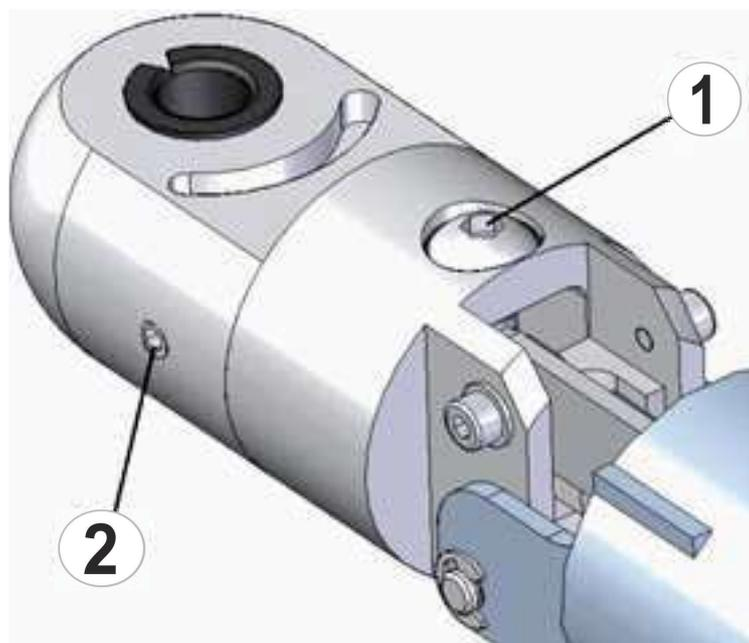
Le positionnement radial/horizontal de la tablette peut être réalisé à l'aide de la vis de réglage.
