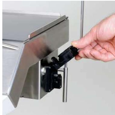
Insérer le tuyau d'irrigation et refermer le couvercle de la pompe. Nous recommandons de soulever le couvercle de la pompe pour insérer le tuyau d'irrigation.
